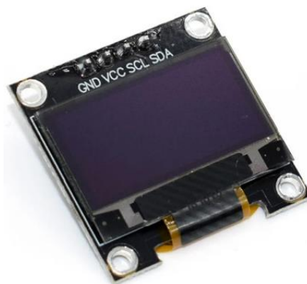
Рисунок 4- OLED displeja modulis 0.96" 128x64 I2C balts NFP1315-61AY та його піни [5]
