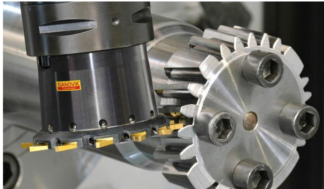
Рисунок 2 – Обробка дисковими фрезами серії CoroMill
