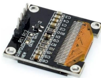
Рисунок. 3- OLED displeja modulis 0.96" 128x64 I2C balts NFP1315-61AY з інтерфейсом I2C [5]
