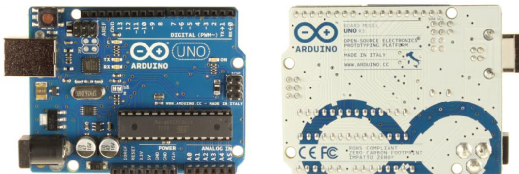
Рисунок 5 - Arduino UNO вид зверху та знизу
