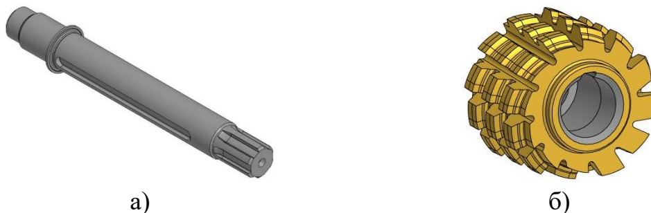
Рисунок 1 - 3D-моделі деталі, що оброблюється (а) та металорізального інструменту (б)
