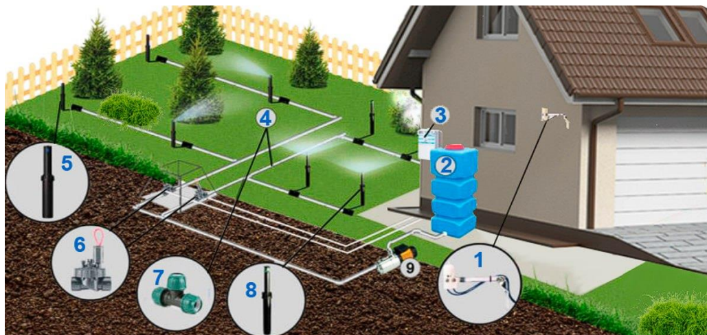
Рисунок .9 – Схема автополива на дворі газона.
