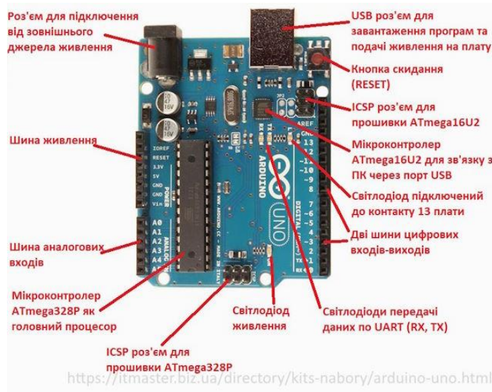
Рисунок 6 – Елементи на платі Arduino UNO [7]
